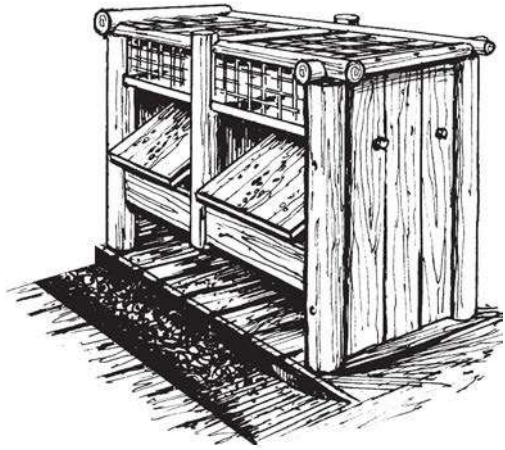
在有漏缝地板的笼子底下装上简单的倾斜地板，就能发挥自动清洁的作用（来自伍德莫拉普 2 ，获批准使用）
